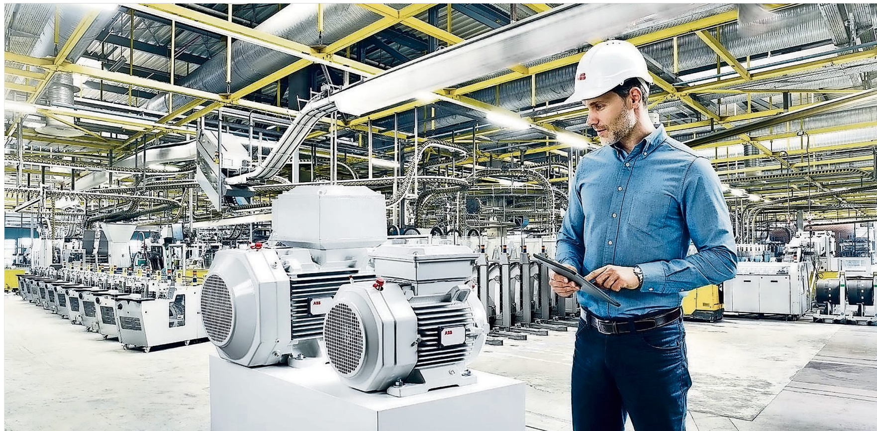
Der ABB Ability Smart Sensor ist eine Remote Condition Monitoring-Lösung, mit der die Anwender über ein Smartphone oder ein spezielles Internetportal den Zustand ihrer Niederspannungsmotoren überprüfen können. Foto: ABB
